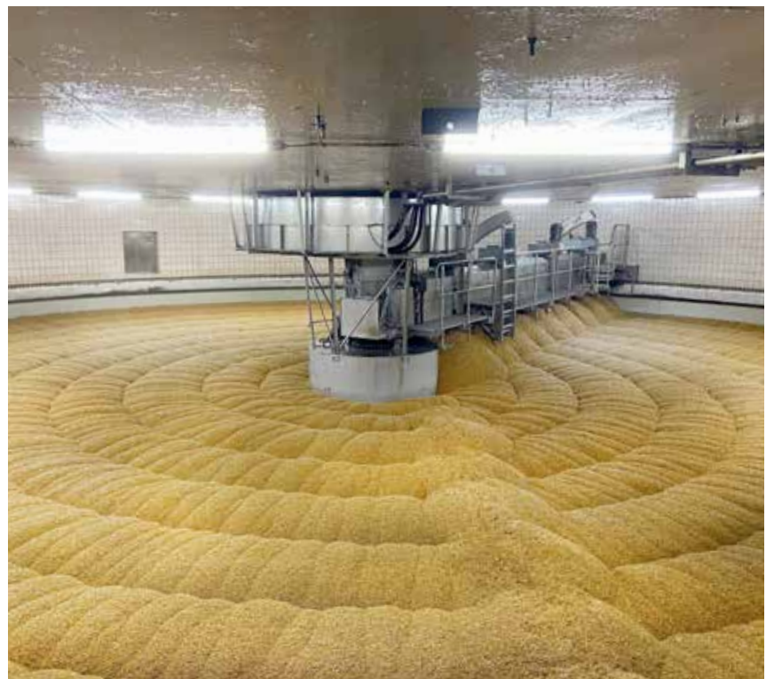
Beim Weichen in der Mälzerei wird die Braugerste gewaschen, um die Keimung zu initiieren
